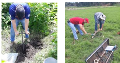
Figura 1. Prueba con cilindros infiltrómetros.
