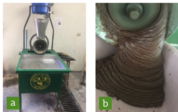
Figura 7. a) Molino industrial. b) Pasta de cacao molido en el molino.
