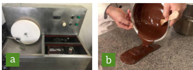
Figura 6. a) Atemperadora. Equipo adquirido en el proyecto cacao-café USAID. b) Manteca de cacao luego del proceso en la atemperadora.
