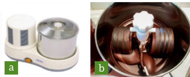
Figura 5. a) Conchadora o refinadora. b) Refinadora en uso. Equipo adquirido en el proyecto cacao-café USAID
