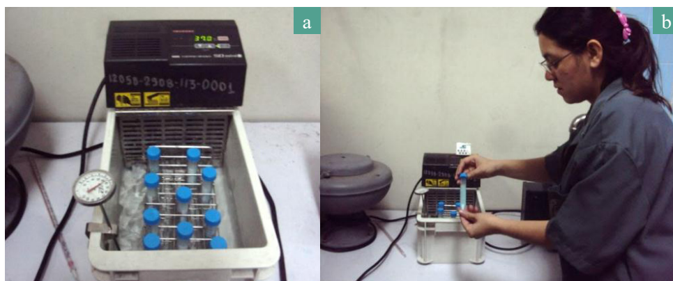
Figura 11. Prueba de reductasa. a) Baño María a 37°C; b) Verificación de cambio de color
