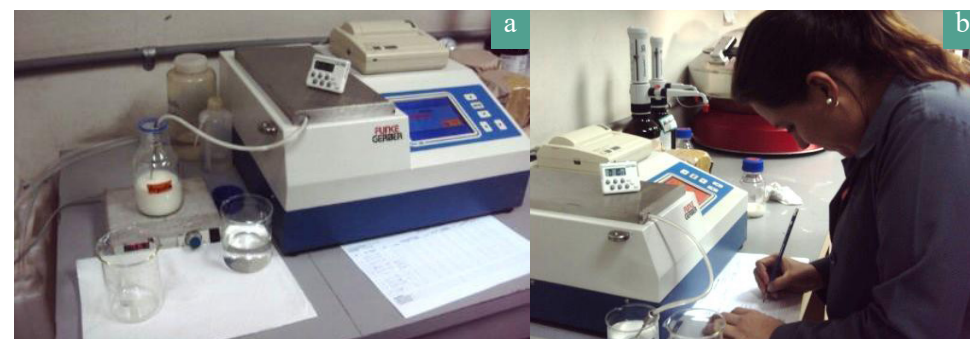
Figura 3. Equipo para determinación físico química de lácteos. a) Equipo Lactostar; b) Procesado de muestras.
