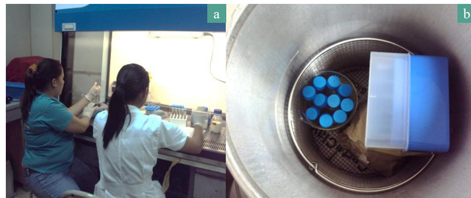
Figura 6. Determinación Bacterias Aerobias Mesófilas y Coliformes. a) Cámara de flujo laminar del laboratorio; b) Materiales en autoclave.
