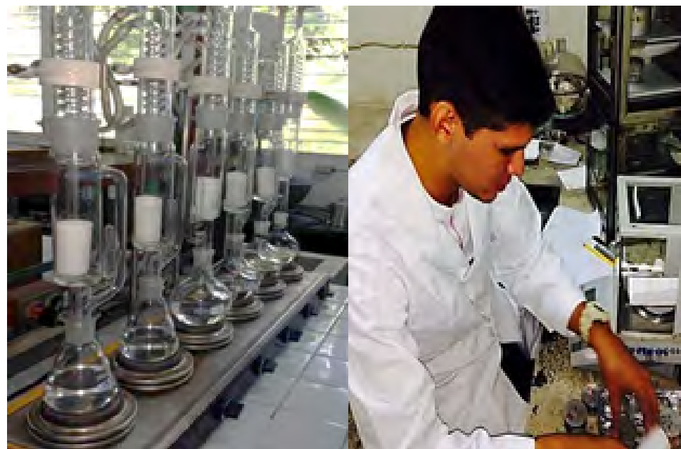
Figura 4. Imágenes de la terminación del extracto etéreo, determinación de humedad y determinación de proteína cruda respectivamente, realizadas dentro del análisis bromatológico y proximal.
