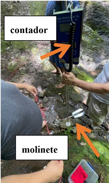
Figura 10 Molinete de cazoleta montado en su base y con contador digital
