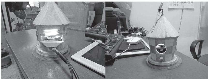
*Nota.* En esta imagen se muestra el nuevo microscopio artesanal elaborado con materiales reciclables diseñado y elaborado por Dr. A. Vásquez. (Registrado en CNR condepósito N° 589-2017).
