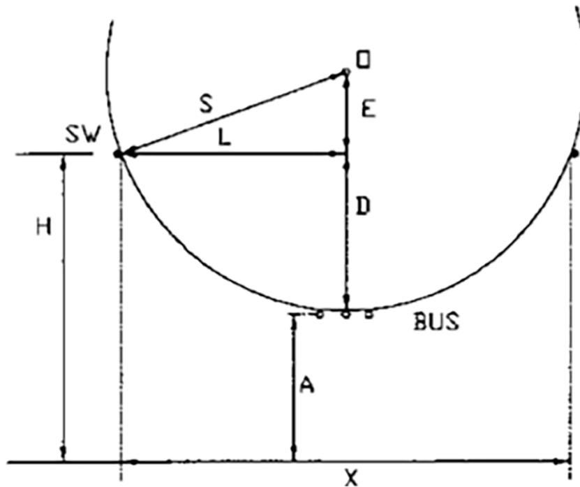
Distancia máxima entre dos cables para recorrido vertical (D debe ser menor o igual que  $H - A$  para protección en altura A).
