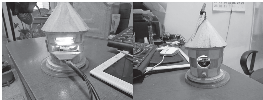
Figura 11. Prototipo nuevo de microscopio artesanal utilizado en el proyecto
