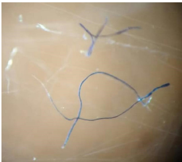
Microfibras de material plástico. Longitud de un lado de la imagen: 1.5 mm.
